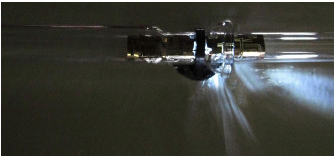
Ovaj sistem aktivira LED belu svetlost od 60K, radijusa od 3m u mračnoj prostoriji. Lampa sadrži niz 3D štampanih metalnih elemenata koji su deo strujnog kola.
